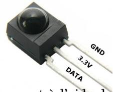
**M** ⇨ Visualiser la tension de la broche DATA du composant à l'aide de l'oscilloscope.
