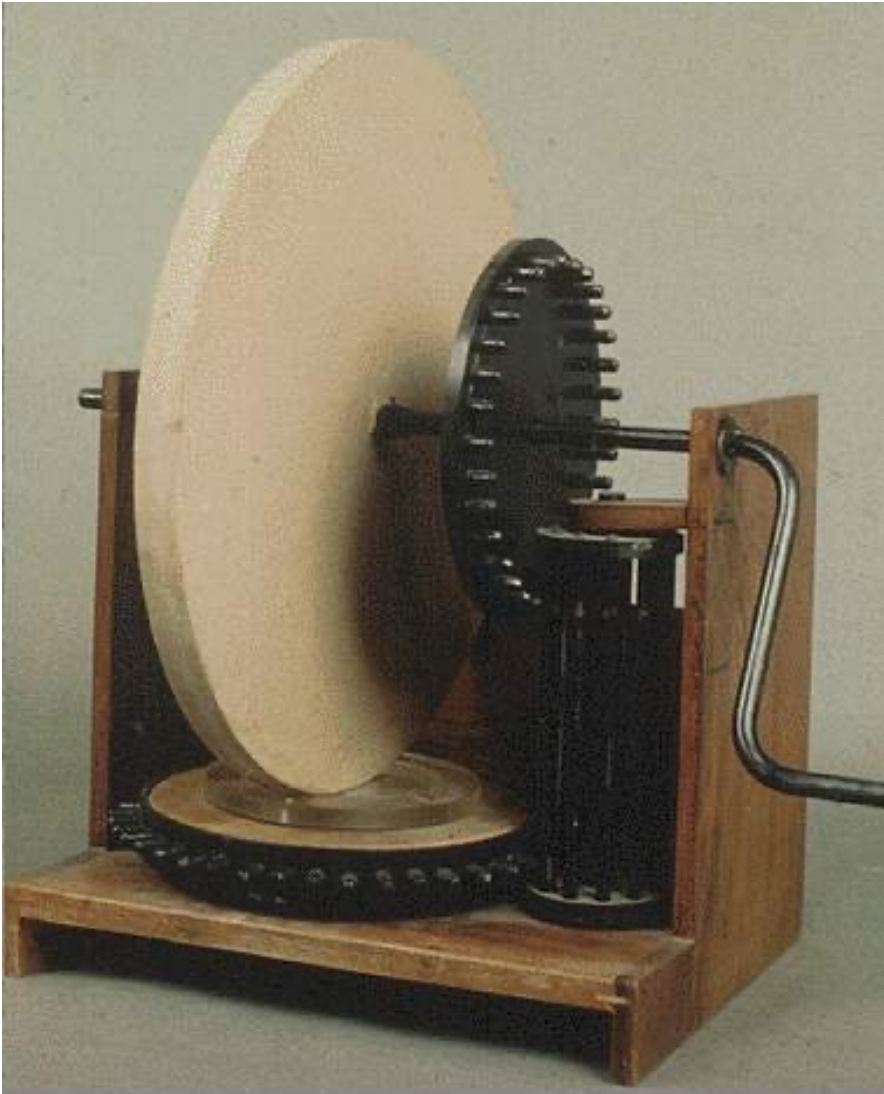
Réplique de la machine à ébaucher imaginée par Leonard de Vinci
