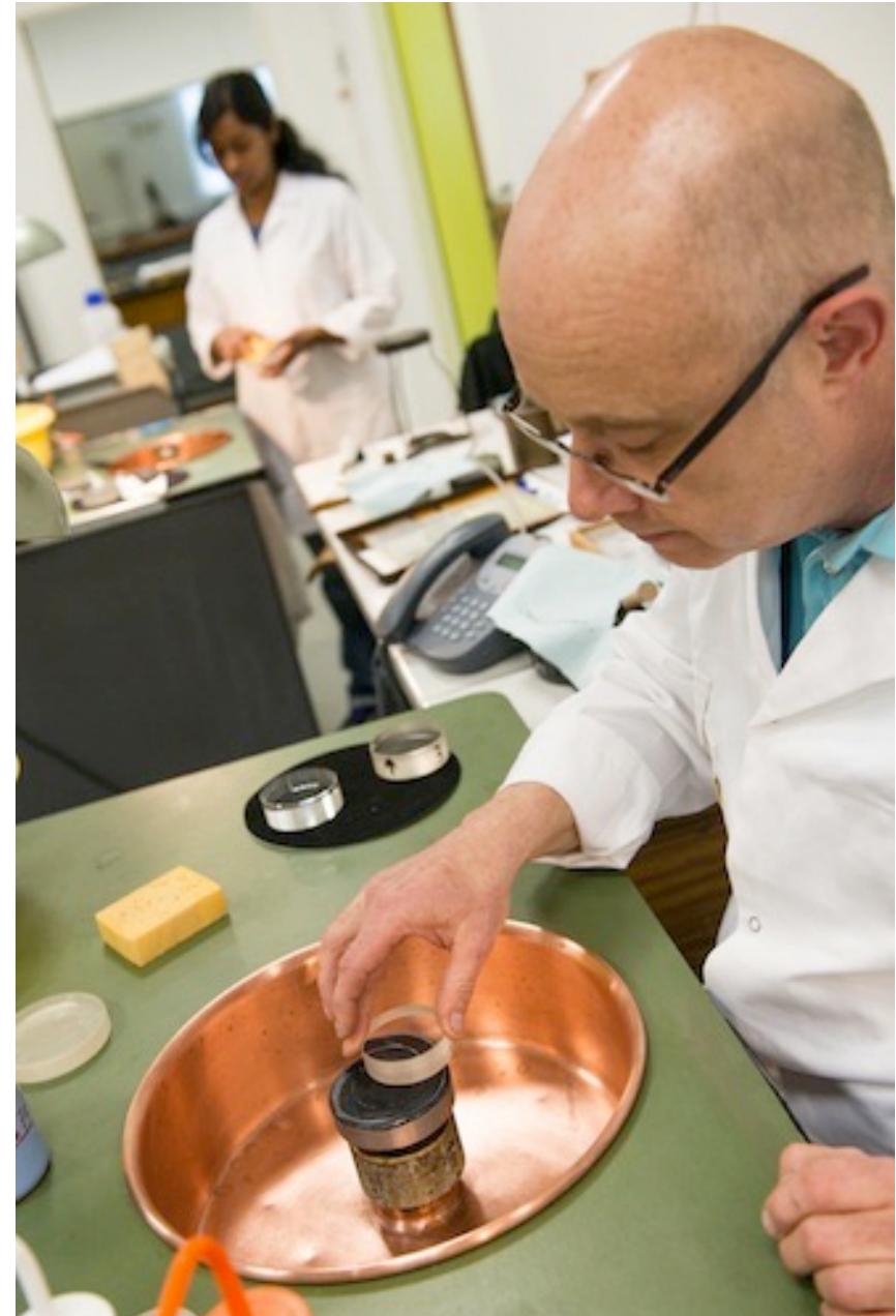
polissage manuel à la poix atelier d'optique de l'Institut d'Optique
