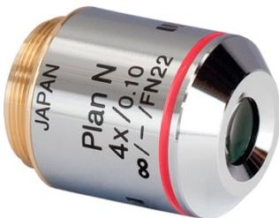
*Remarque : Dans un objectif de microscope la conjugaison objet-image est contrainte par le tube du microscope. L'objet est donc positionné à une distance frontale fixe et la qualité (liée à l'ouverture) est optimisée pour cette conjugaison. L'ouverture numérique objet est fixe et est donc inscrite sur le corps de l'objectif :  $ON_{\text{objet}} = 0,10$  sur l'image.*
