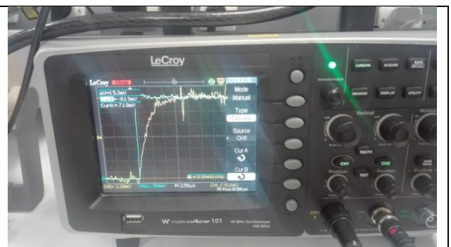
Figure 3.1.b – Réponse du circuit à un signal carré pour une résistance R_p = 10k\Omega (LED rouge et photodiode SFH206)
