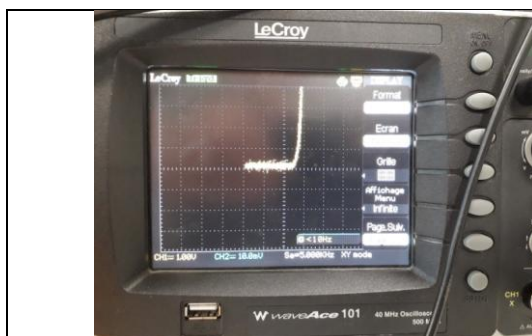
Figure 2.2.a – Caractéristique de la photodiode SFH206 non éclairée
