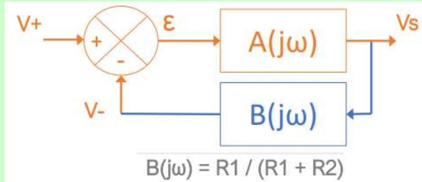
$B(p) = V_-(p)/V_S(p) = R_1/(R_1 + R_2)$  si  $R_2$  est la résistance de contre-réaction et  $R_1$  la résistance à la masse.
