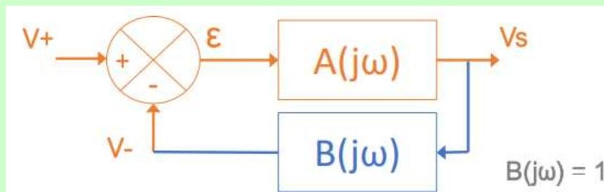
5. Calculez la fonction de transfert en boucle fermée de ce montage.
