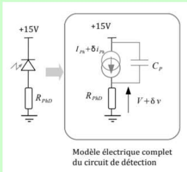
On peut modéliser une photodiode par une source parfaite de courant (dont l'intensité dépend du nombre de photons reçus) en parallèle d'une capacité. La source de tension continue  $V_{CC}$  permet de polariser la photodiode et de diminuer la valeur de la capacité parasite.
