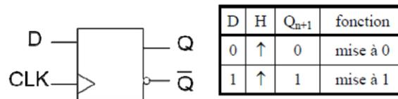
Pour un chronogramme de D comme le suivant (avec ici une horloge périodique), tracer superposé au diagramme de D le chronogramme de la sortie,  $Q(t)$ , d'une autre couleur de crayon. Y a-t-il besoin de tracer l'autre sortie ?
