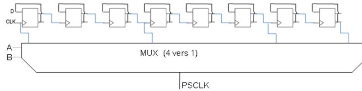
1. Que fait le dispositif « PSC » au signal CLK en fonction des deux entrées du MUX, A et B ? (huit bascules D avec sorties Q et complémentaire)
