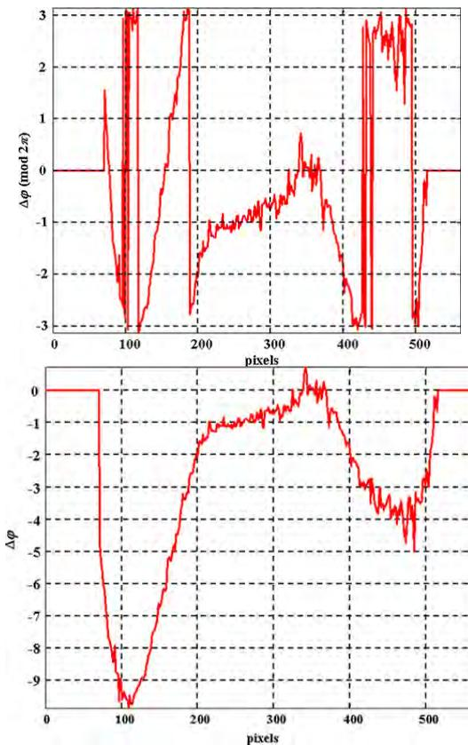
*Fig 8 : Déroulement de la phase à une dimension*
