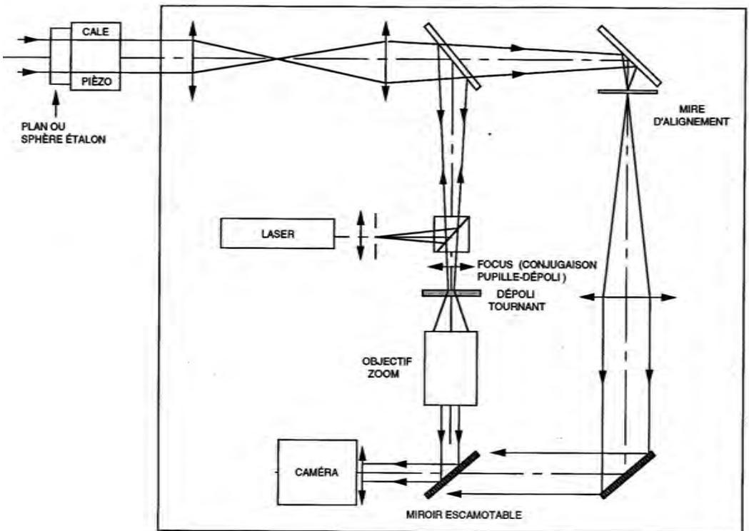
Fig 11 : Schéma de l'interféromètre « Zygo » Ou « Zygoto »
