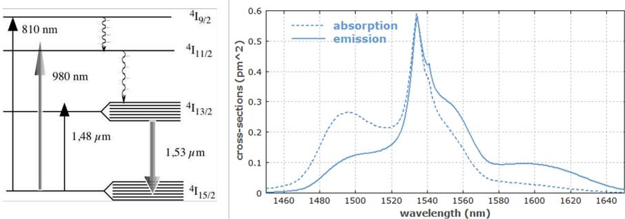
**FIGURE 3.3** – Spectroscopie du système  $\text{Er}^{3+}:\text{SiO}_2$  (gauche) et sections efficaces effectives d'absorption et d'émission pour la transition laser autour de  $1.53 \mu\text{m}$  (droite).
