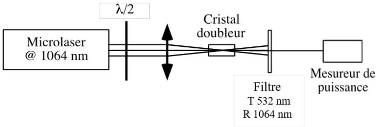
**FIGURE 4.3** – Schéma de montage du doublement de fréquence
