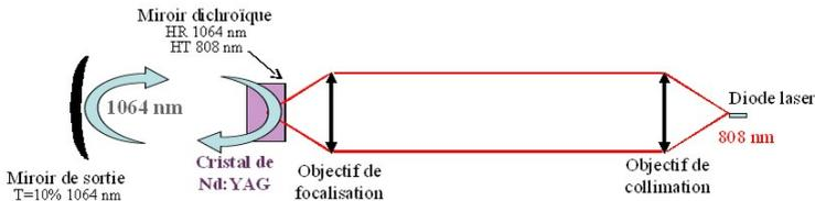
Figure E3 : Schéma de l'optique de pompage.
