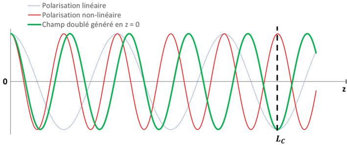
**FIGURE 4.6** – Représentation des polarisations linéaire et non-linéaire d'ordre 2 générées par un champ électrique intense, ainsi que le champ électrique doublé généré par la polarisation non-linéaire en  $z = 0$ .
