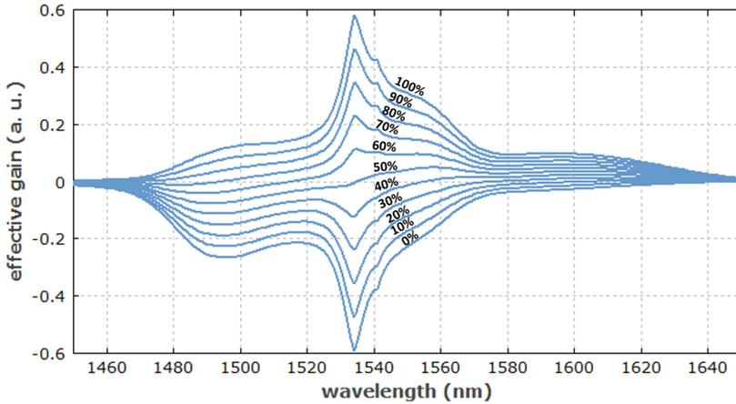
**FIGURE 3.4** – Gain linéique effectif déduit des sections efficaces effectives en fonction de la longueur d'onde. Les courbes du bas vers le haut sont pour un degré d'excitation  $n_1/n_t$  de 0% à 100% par pas de 10%.
