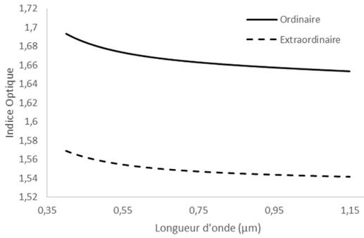
**FIGURE 4.10** – Indices optiques ordinaire extraordinaire du BBO en fonction de la longueur d'onde
