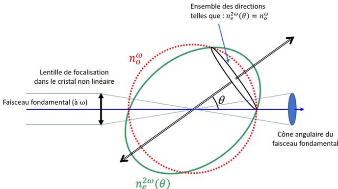
**FIGURE 4.9** – Comparaison en 3D des directions d'accord de phase et des angles compris dans le faisceau fondamental focalisé dans le cristal doubleur de fréquence
