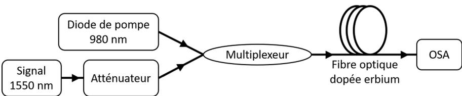
**FIGURE 3.1** – schéma de principe du système étudié.
