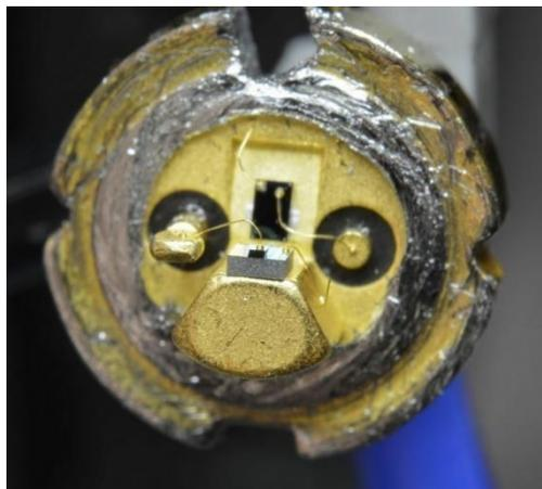
**Lasers:** deux lasers peuvent se récupérer dans les lecteurs de DVD l'un émettant dans le rouge (650 nm), l'autre dans le proche IR (780 nm), on peut obtenir le faisceau rouge du laser visible en soudant deux fils (ce qui n'est pas facile) et en utilisant une alimentation (ou des piles) avec une tension de 3V à 6V.
