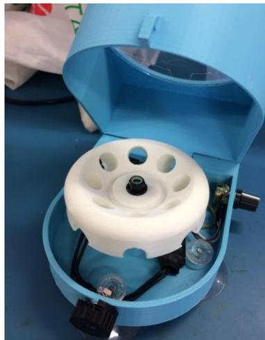
Exemple 2 : Utilisation d'un **moteur de drone** (avec son électronique) + **impression 3D**: 64 €
